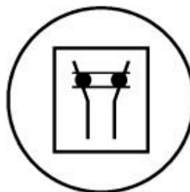
Рисунок L.2. - Символ маркировки аппарата, содержащего механически связанные контакты
