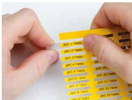
Установить тег в трубчатый держатель
