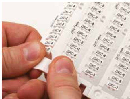
Отделить маркировочные элементы
