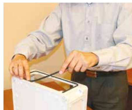
3. Установите уплотнитель на оба объединяемых корпуса
