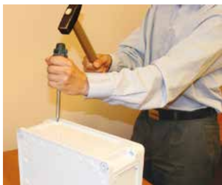
1. Удалите соединительные отверстия
