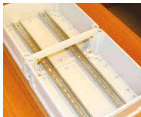
6. Стяните болтами, установите DIN-рейки
