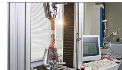
Испытания наконечников на разрывное усилие
