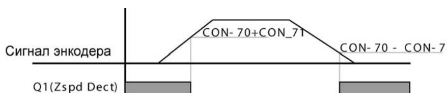
Выход включается на основе сигнала энкодера. Во время включения/выключения может возникать ошибка из-за помех сигнала энкодера или постоянной времени фильтра.
