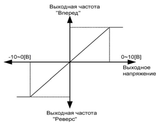
**IN-12 V1 –volt x1’~ IN-15 V1 –Perc y2’:** Установка диапазона и сдвига шкалы частоты для аналогового входа.
