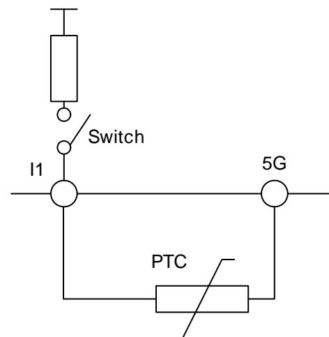
**IN-65~75 Px Define, IN-82 DI NC/NO Sel:** Параметры позволяют использовать термодатчик типа биметаллического реле, подключенный к одному из дискретных входов преобразователя. Подключите термодатчик к дискретному входу, запрограммируйте вход на функцию 39 (Thermal In) и установите параметр IN-87 1(NC) – тип входа нормально закрытый.
