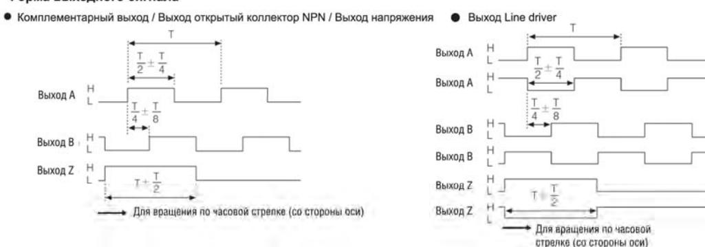
**АРО-05 Enc Pulse Sel** : Установка направления считывания импульсов энкодера. Для вращения в прямом направлении задайте 0 (A+B), для вращения в обратном направлении задайте 2 -(A+B). Для работы платы энкодера как источника задания частоты выберете 1.
