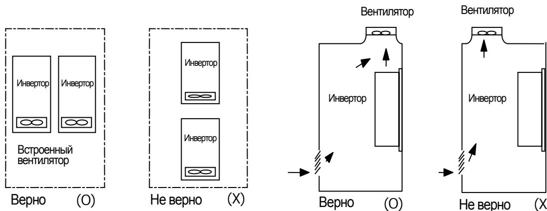
При установке двух преобразователей в панели
