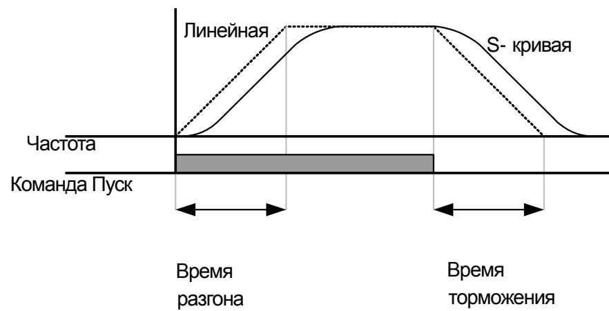
**ADV-03 Acc S Start:** Параметр задает растяжку кривой разгона S-типа. Используется для настройки сглаженной части кривой при начале разгона. Параметр определяет отношение длины сглаженного участка разгонной кривой, к длине кривой, требуемой для разгона до  $\frac{1}{2}$  заданной частоты. Например: если ADV-03 Acc S Start установлен в 50% и заданная частота равна 60 Гц, то разгон от 0 до 15 Гц будет по сглаженной кривой, а разгон от 15 до 30 Гц будет по линейной зависимости.
