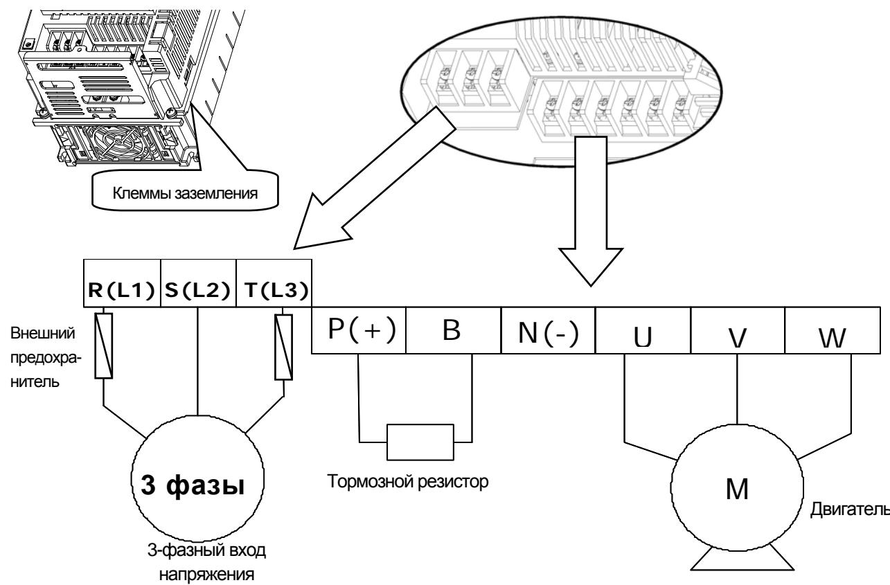
2) Расположение клемм для частотных преобразователей с мощностью 11 – 22 кВт
