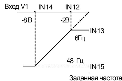
Для установки диапазона 0 – +10В установите параметры IN-08 V1 Volt X1 – IN-11 V1 Perc y2.
