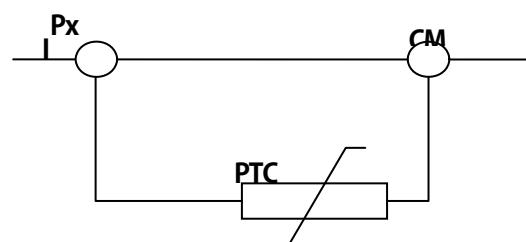
**PRT-36 Thermal-T Lev:** установка уровня срабатывания для температурного датчика, подключенного к аналоговому входу. Максимальный уровень напряжения для входа V1 составляет 10В, для входа I1 составляет 5В. Например, если уровень срабатывания датчика, подключенного к токовому входу установлен в 50%, то он сработает при 2,5В.
