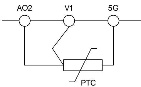
Измерение напряжения производится при помощи постоянного тока с выхода AO2 и сопротивления изменяющегося в зависимости от температуры
