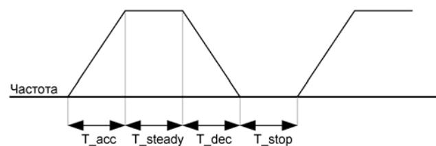
$$\text{Пример 2) } \%ED = \frac{T_{dec}}{T_{dec} + T_{steady1} + T_{acc} + T_{steady2}} \times 100[\%]$$
