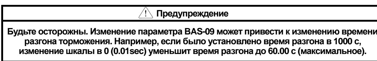
2) Установка времени разгона/торможения рассчитываемого на основании текущей частоты
