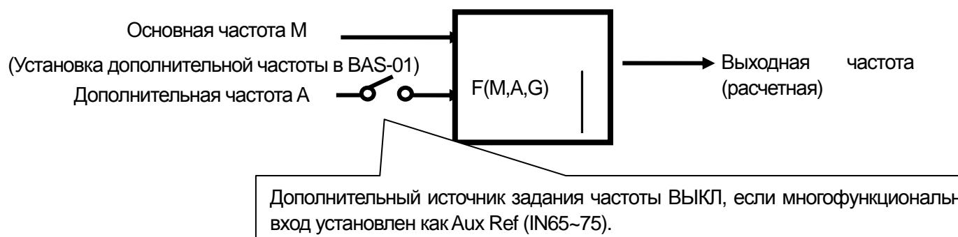
**Пример 1)** Основная частота задается с клавиатуры, уточнение частоты задается с аналогового входа V1.
