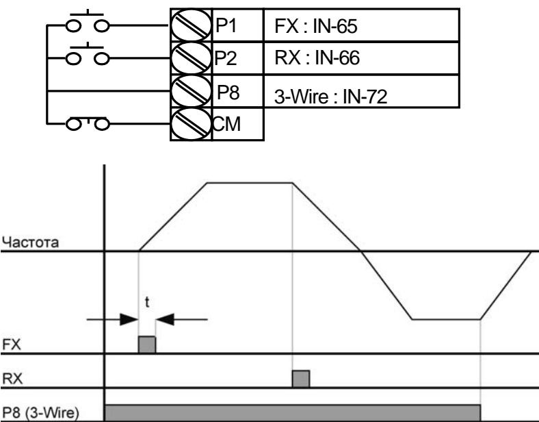
**8.1.5 Режим безопасного управления (отключение работы по внешнему сигналу)**
