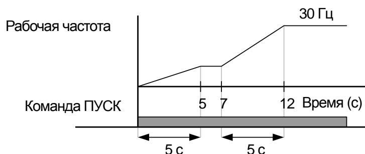
3) Установка скорости разгона/торможения при помощи дискретных входов
