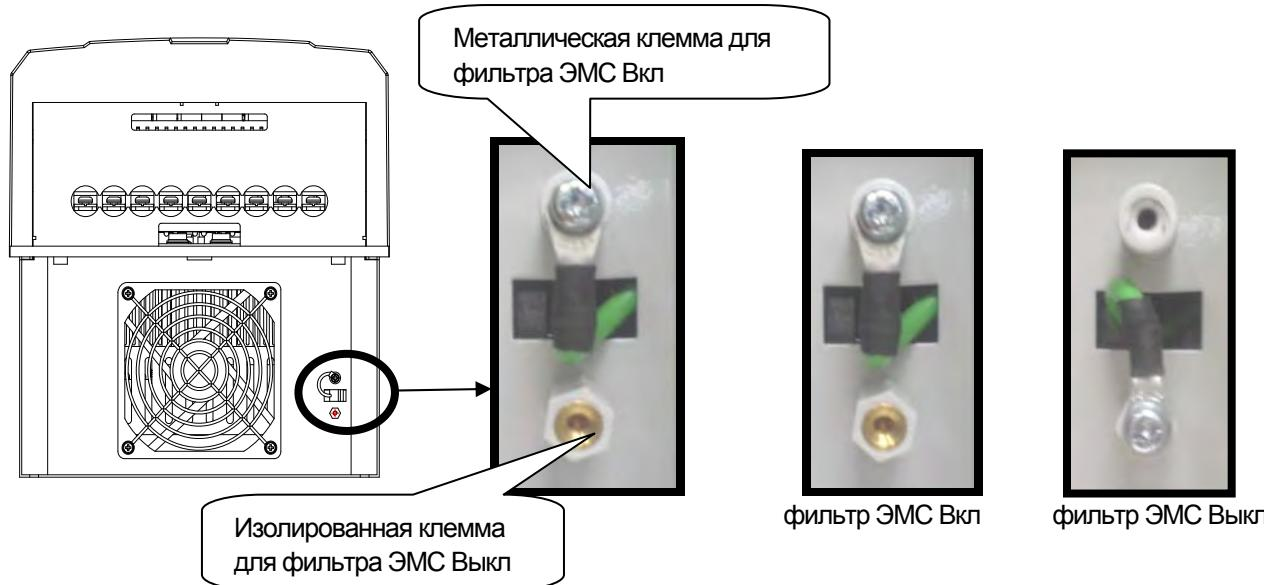
Фильтр ЭМС предназначен для уменьшения влияния электрических помех при использовании с источником питания симметричного способа заземления, такого как подсоединение Y.
