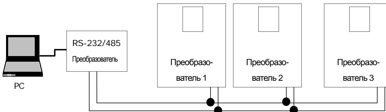
Подключение по RS-485: подключите к клеммам S+, S- (См. главу 4 "Подключение")
