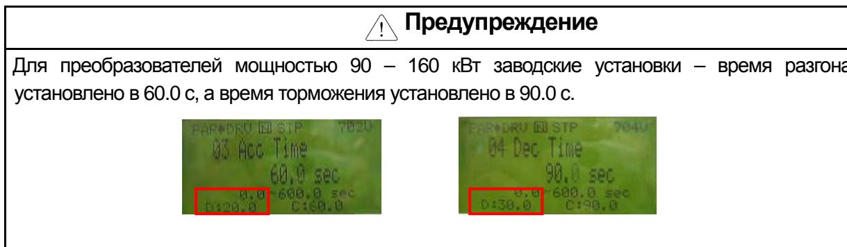
**BAS-09 Time scale:** Изменение масштаба задания времени разгона/торможения. Используется для более точного задания временных параметров.
