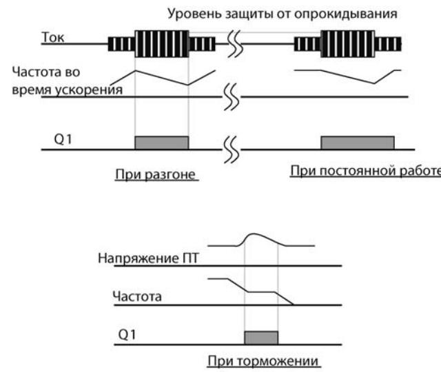
**PRT-51 Stall Freq 1 ~ PRT-58 Stall Level 4:** Можно установить несколько уровней защиты от опрокидывания для разных частот и для базовой частоты. Нумерация уровней по частоте начинается с низких частот. Например, значение Stall Freq2 находится посередине между Stall Freq 1(нижний уровень) и Stall Freq 3(верхний уровень).
