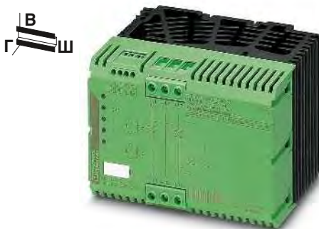
для реверсирования 3-фазных двигателей переменного тока до 575 В перем. тока/3 x 16 A
