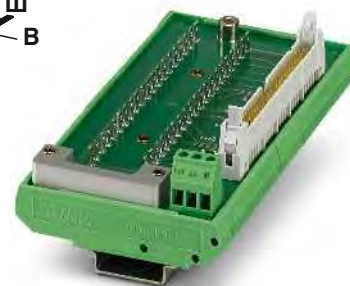
Преобразователь для SIMATIC® S5-95U на 50-контактную штыревую планку IDC/FLK
