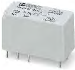
Реле с 2 переключающими контактами, макс. 2 x 8 А
