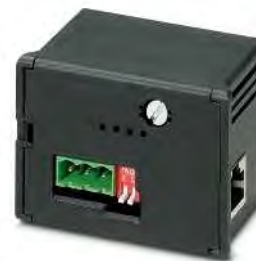
Шлюз Ethernet со встроенным веб-сервером
