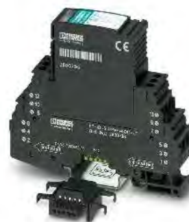
5 проводников, с общим опорным потенциалом, подключение 9/10, заземление через газовый разрядник
