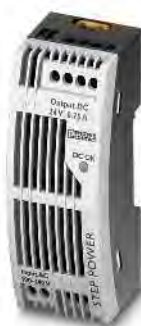
Источник питания, 1-фазный, 24 В DC, 0,75 А плоская конструкция, NEC, класс 2
