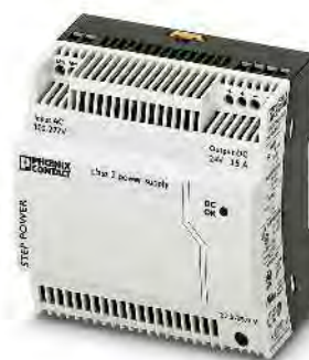
Источник питания, 1-фазный, 24 В DC, 3,5 А Вход до 277 В AC, NEC, класс 2
