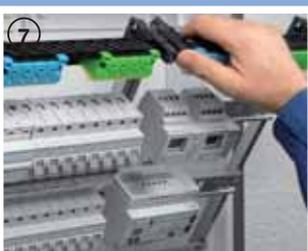
Система несущих стоек с дин-рейками съемная, позволяет проводить сборку вне корпуса щита. После подключения аппаратов готовая сборка фиксируется в корпусе щита с помощью надежных безвинтовых соединений.
